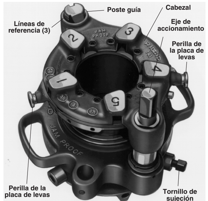
Figura 22 – Roscador a engranajes No. 141 mostrando la manga del piñón y las líneas de referencia en el poste guía
