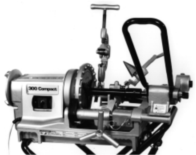
Figure 20 – Rainureuse à galets modèle 916 et adaptateur montés sur la 300 Compact.
